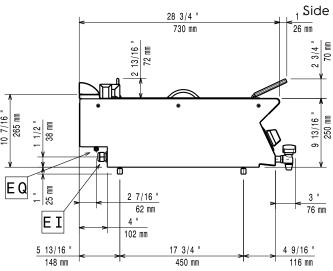
Electrical inlet (power) **Equipotential screw**
